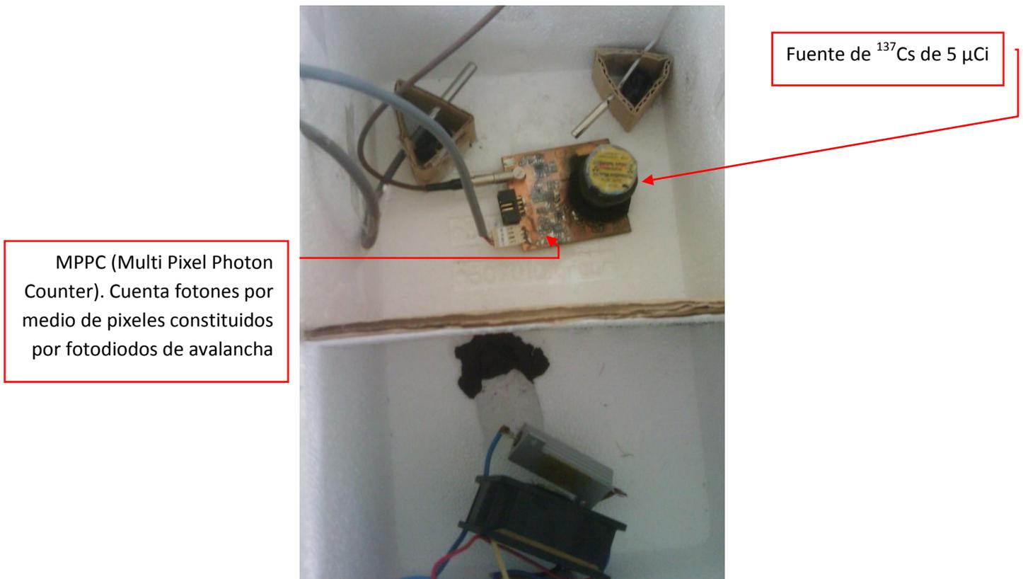
Figura 15: Montaje para la adquisición de medidas de la variación de la ganancia de los SiPM con la temperatura
